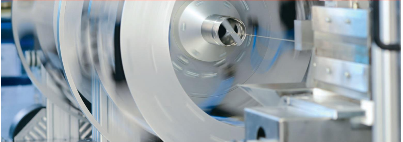
Mikropullwindinganlage zur Herstellung von miniaturisierten Profilen aus Faserverbundkunststoff.
