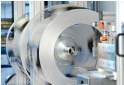
Mikropullwindinganlage zur Herstellung von miniaturisierten Profilen aus Faserverbundkunststoff (Quelle: Fraunhofer-Institut für Produktionstechnologie IPT)
